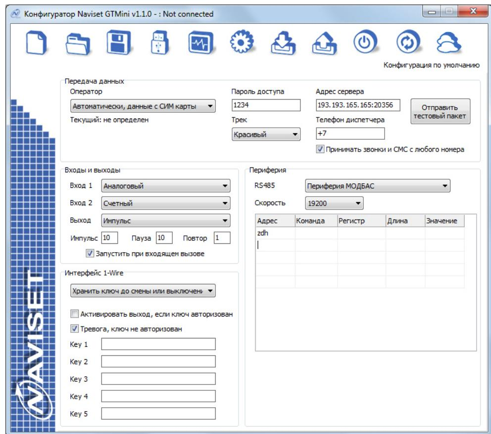
Для локальной настройки прибора скачайте с сайта [www.naviset.su](http://www.naviset.su) последнюю версию конфигуратора и установите ее. Установка драйвера устройства производится автоматически при установке конфигуратора. Если текущая версия конфигуратора требует обновления, то при наличии интернет на ПК будет предложено обновиться до последней.
