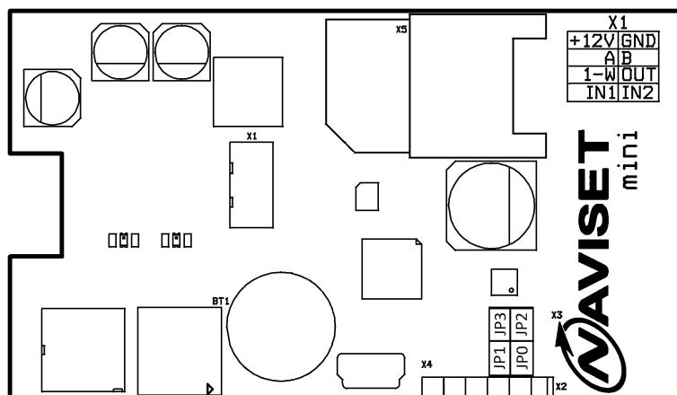
**X1** – Разъем для подключения интерфейсного кабеля. Назначение контактов:
