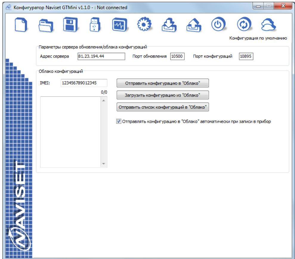
Так же без подключения к прибору можно загрузить конфигурацию из облака в конфигуратор для дальнейшего изменения и сохранения обратно в облако. Для этого нужно знать IMEI прибора для которого выгружается конфигурация. Если прибор подключен по USB - IMEI определяется автоматически.
